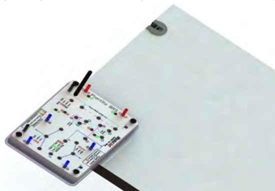
Marcado de caja a 50mm del borde frontal
